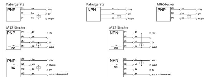
Bei Geräten mit M12-Stecker und Öffnerfunktion (nc) wird der Schaltausgang über PIN2 angeschlossen. Es ist daher eine 4-adrige Kabeldose zu verwenden. Der Anschluss erfolgt über die weiße Ader.
