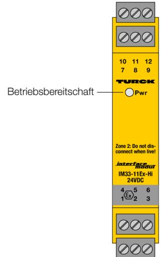
Über den 1-kanaligen HART®-Messumformer-Speisetrenner IM33-11EX-HI/24VDC werden eigensichere HART®-2-Draht-Messumformer (III) im Ex-Bereich betrieben und das Messsignal in den Nicht-Ex-Bereich übertragen. Neben den Analogsignalen können bidirektional auch die digitalen Signale der HART®-Kommunikation übertragen werden.
