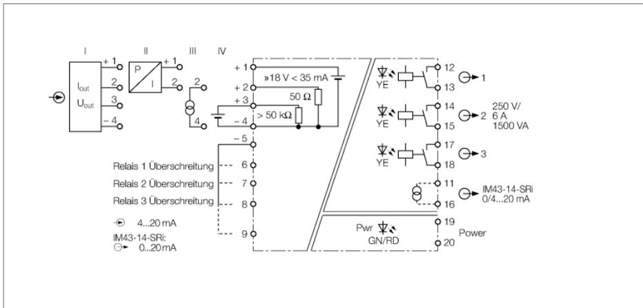
Der 1-kanalige Grenzwertsignalgeber IM43-14-SRI überwacht alternativ Messströme von 0/4...20 mA oder Messspannungen von 0/2...10 V auf Überschreitung und Unterschreitung von Grenzwerten.
