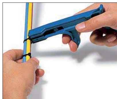
Werkzeug ansetzen, Kabelbinder spannen.
