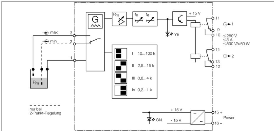
Mit dem einkanaligen Niveauwächter MK91-12-R/24VDC können Füllstände von leitenden Flüssigkeiten überwacht und geregelt werden.
