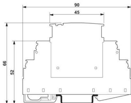
Abbildung zeigt das Kompletmodul, bestehend aus Basiselement und Stecker
