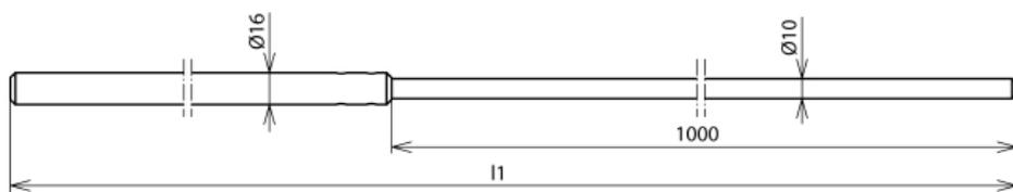
Fangstange mit Verjüngung (1000mm) angefast, zum Schutz von Dachaufbauten, Kaminen usw., speziell für Betonsockel (17kg) mit Keiltechnik oder für die Befestigung mit Stangenhaltern/Distanzhaltern.
