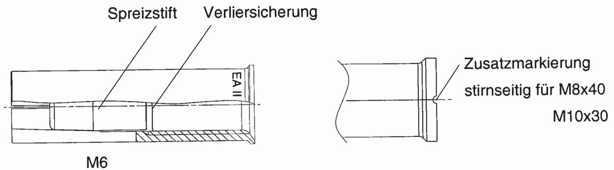
Einbauzustand: Nur für die Verwendung als Mehrfachbefestigung von nicht tragenden Systemen gemäß ETAG 001 Teil 6
