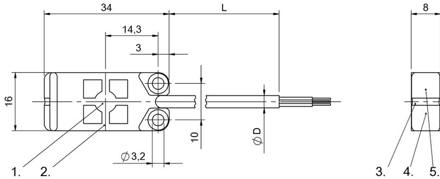
1) aktive Fläche, 2) Gehäuse, 3) Deckel, 4) Betriebsspannungsanz. grün, 5) Funktionsanzeige gelb
