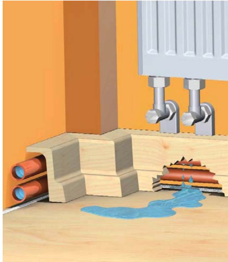
Einsatz einer Zwillingselektrode zur Detektion einer Leckage unter einer rohrleitungsführenden Fußleiste
