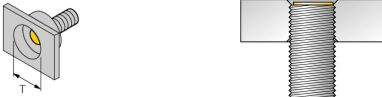
Bei allen bündigen *uprox®+* Gewinderohrschaltern ist ein überbündiger Einbau erlaubt. Bei einem zurückgesetzten Einbau von einer halben Gewindeumdrehung ist ein sicherer Betrieb gewährleistet.
