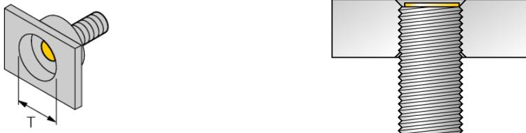
Bei allen bündigen uprox®+ Gewinderohrschaltern ist ein überbündigter Einbau erlaubt. Bei einem zurückgesetzten Einbau von einer halben Gewindeumdrehung ist ein sicherer Betrieb gewährleistet.
