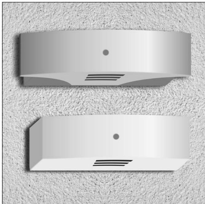
Der optische Rauchschalter ORS 142 W erkennt frühzeitig sowohl Schmelzbrände als auch offene Brände mit Rauchentwicklung. Ein zusätzlicher Temperaturfühler spricht bei einer Umgebungstemperatur von 70 °C an. Er wird eingesetzt als Sturzmelder in Feststellanlagen. Seine Spezifikationen stimmen mit denen des ORS 142 überein.
