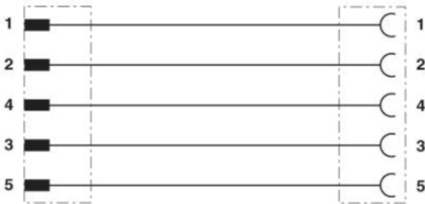
Schaltplan Kontaktbelegung des M12-Steckers und der M12-Buchse
